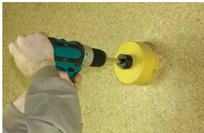
Hulsav med udkast til indblæsningshuller i mange forskellige materialer.
